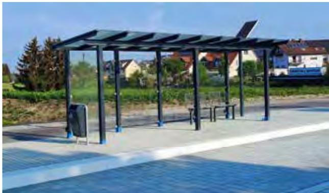
Die neue Haltestelle besteht aus Stahlprofilen mit Sicherheitsverglasung, speist ihre Beleuchtung aus einem eigenen Solarpanel und bietet vier Sitzplätze. Der Haltestellenbereich ist gepflastert und beinhaltet natürlich auch ein Leitsystem mit Bodenindikatoren für Sehbehinderte.
