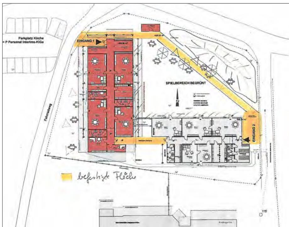
Auf der Planzeichnung ist in rot die geplante Erweiterung der Containeranlage zu sehen.
